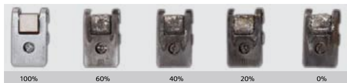
FOTO 5.2 DESGASTE DE LOS CONTACTORES
